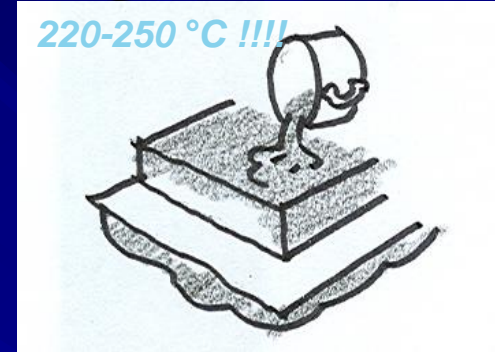
Pod litý asfalt - silniční i železniční mosty
